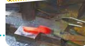
金属の先の部分を整えた後（半形）、程よい大きさで切り落とし、中子（包丁の持ち手にさす部分）をつくります。
