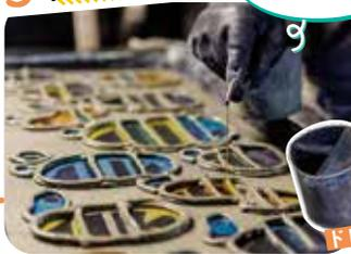
土手に「ドヒン」と呼ばれる道具を使って、染料を注ぎます。同時に裏から吸引し、生地に均等に染料を浸透させます。裏面にもこの作業を行います。
