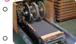
専用の機械で、必要な長さにカットした後、少し時間を置きます。
