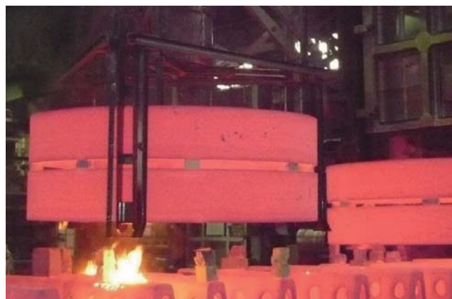
開発を施した大型リング専用吊り用具
