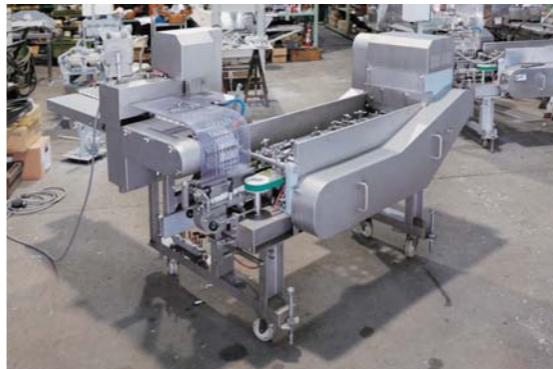
魚体から内蔵を抜いてブツ切りにする機械TOYO-82Lは、開発されて久しいベストセラー製品。
