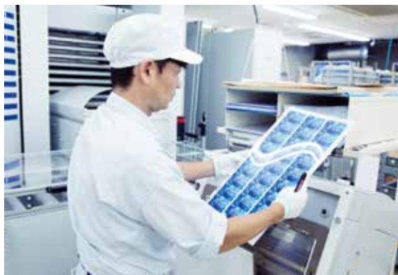
全自動ラミネートプレスシステムで4層に仮積層されたシート材料を熱と圧力で加熱融着して一体化させている。
