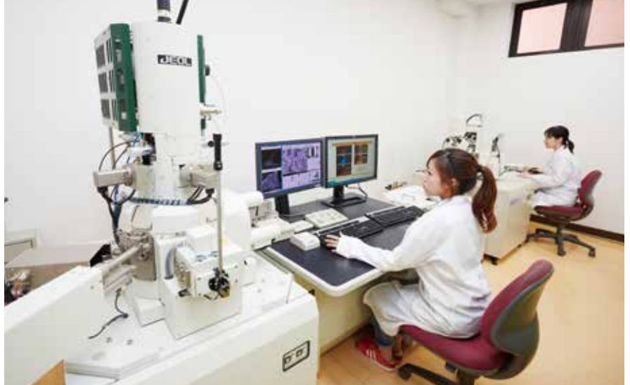
電子部品の接合部の「結晶方位解析装置」。元素の状態までを解析することができる。
