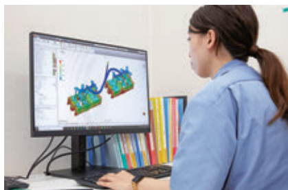
金型内で起こりうるさまざまな現象を3Dで確認することができる「流動解析ソフト」を使い、高品質な製品作りを実現。
