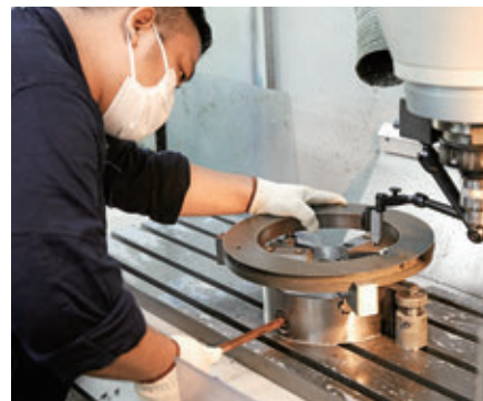
今では得意の金属や樹脂だけでなく、人工大理石の切削もこなしている。写真はNCフライス盤による穴あけ加工。
