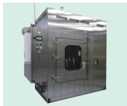
容器に付着した臭気を除去する温水蒸気洗浄機「エコウォッシュ」。温水・蒸気・乾燥を全自動で行う。
