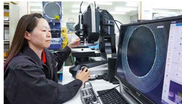
製品に亀裂やひび割れなどが無いマイクロスコープで検査。
