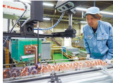
「高周波ロウ付機」の導入により、高品質な製品づくりが可能に。
