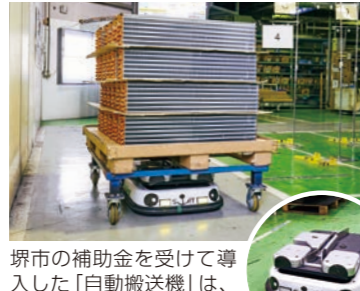
堺市の補助金を受けて導入した「自動搬送機」は、重い部材を所定の位置に自動で運ぶスグレモノ。
