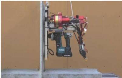
子機によるコンクリート板の穴あけ実験
