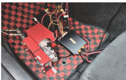
開発事例：車の走りを楽しみたいという下肢障がい者向けMT車クラッチ操作補助装置
