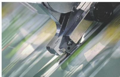
長尺ロールのフィルムを切断するスリッター
