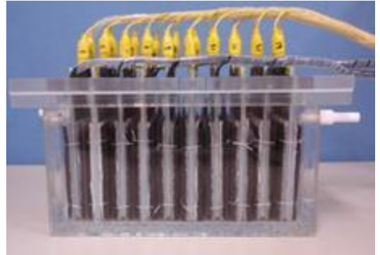
廃水処理用微生物燃料電池の実験装置
